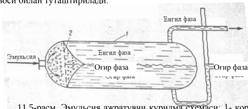
11.5-расм. Эмульсия ажратувчи курилма схемаси: 1- корпус; 2- перфорацияланган тўсиқ.
