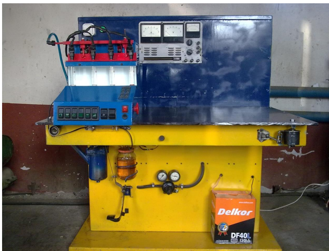
10-Расм. Инжектор тизими форсункаларининг иш қобилиятини текшириш ва уни таҳлил қилувчи лаборатория стендининг умумий кўриниши
