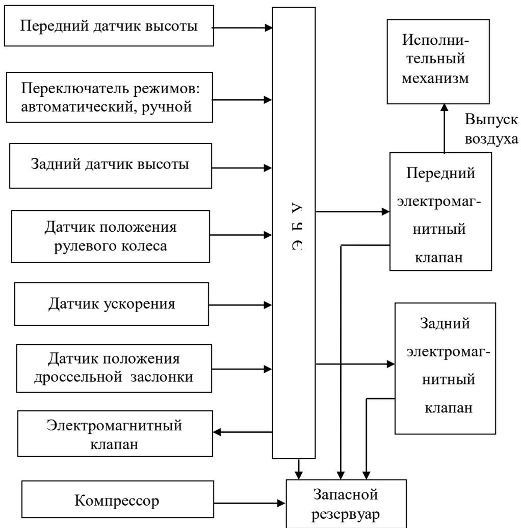
Рис. 26.2. Структурная схема управления жесткостью подвески автомобиля "Toyota"
