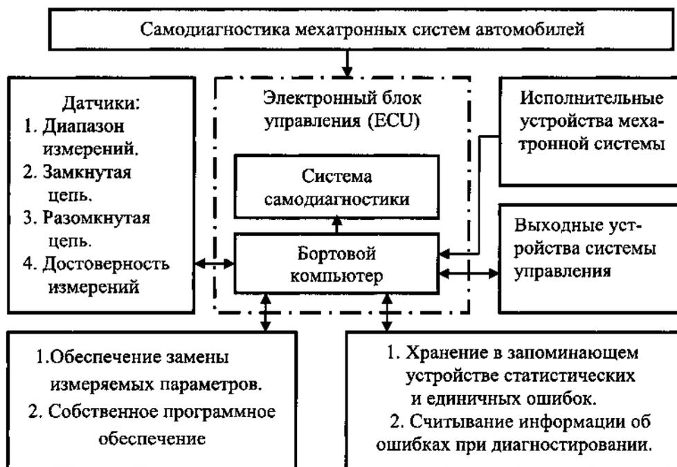
Рис.21.2. Структурная схема самодиагностики мехатронных систем автомобилей
