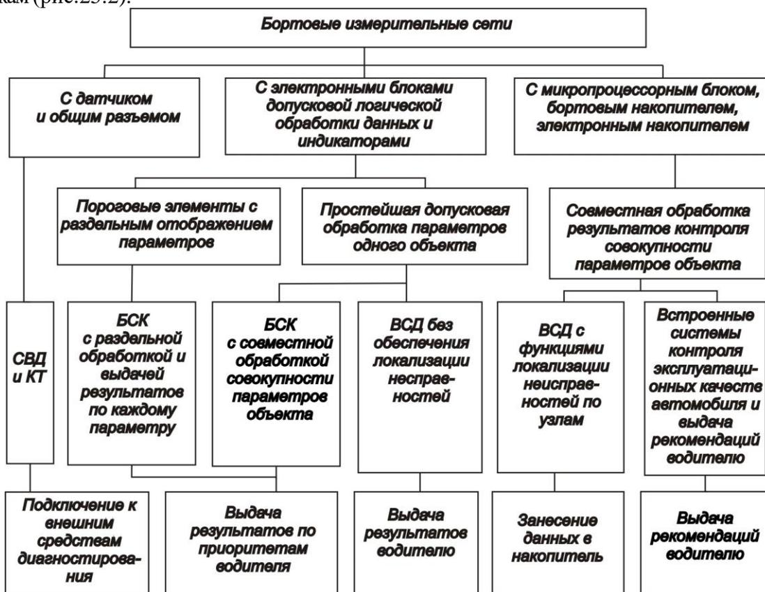
Рис. 25.2. Классификация встроенных средств диагностирования
