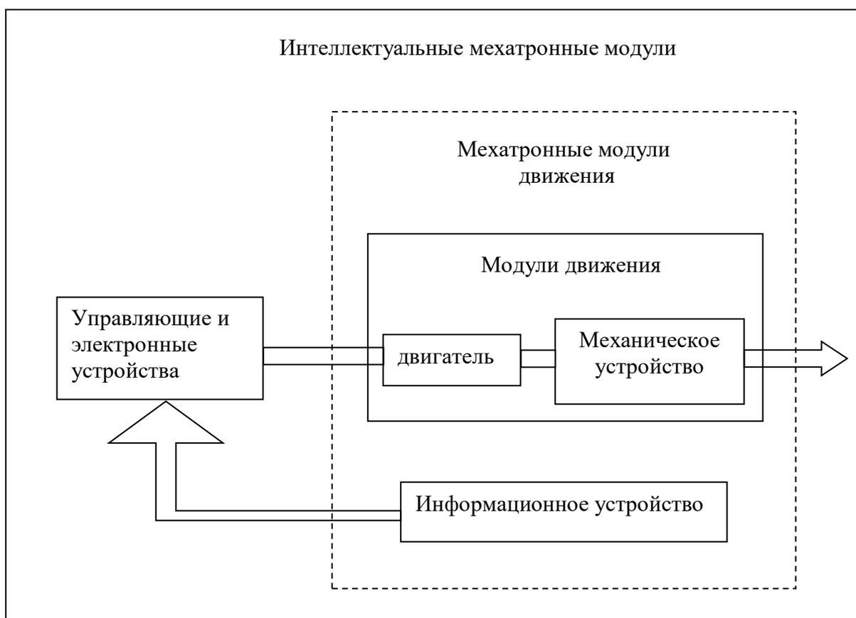
Рис. 3.3. Классификация мехатронных модулей
