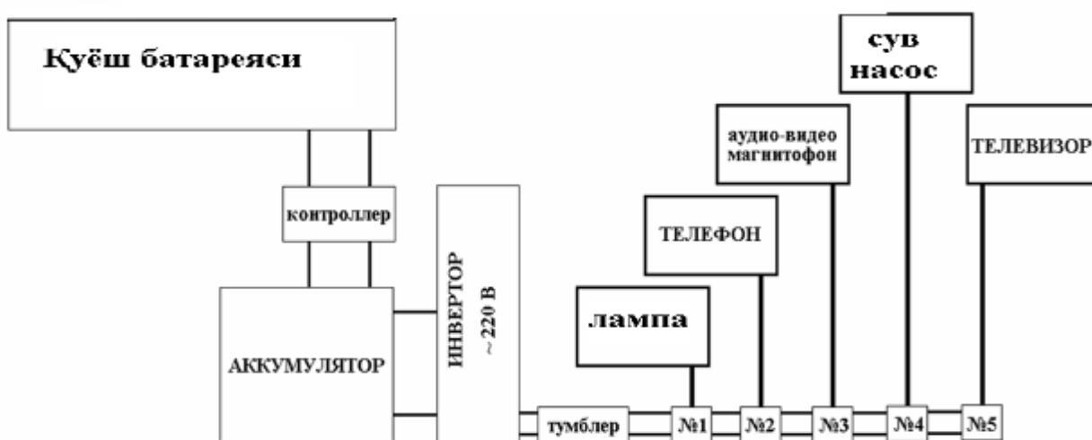
20-rasm. Quyosh elektr stansiyasining strukturasi.
