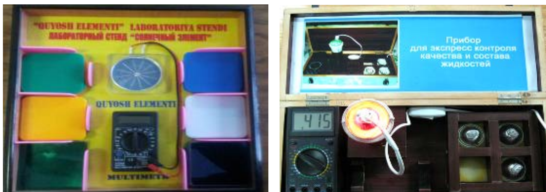
39-rasm. Har xil suyuq va qattiq jismlarda yorug'likni yutilish qonuni o'rganishga mo'ljallangan «Quyosh elementi» laboratoriya stendlari
