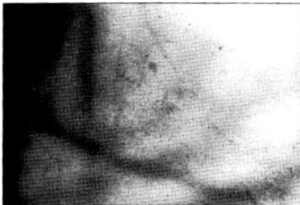
Рис. 2.7. ПЭМ-изображение поверхности Si (100) КДБ, полированной композицией коллоидного кремнезема, ( \times 17500 ), дислокации обработки отсутствуют.
