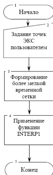
Рис.3.10. Схема алгоритма синтеза ЭКС с использованием кубических сплайнов
