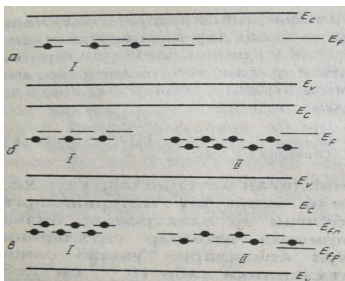
1.13-rasm. Yarimo'tkazgichning yorug'likka sezgirligini oshirishni tushuntirish modeli: a-yorug'likka sezgirligi past fotoo'tkazgich qorong'uda; b-yorug'likka sezgirligi oshirilgan fotoo'tkazgich qorong'uda; v-yorug'likka sezgirligi oshirilgan fotoo'tkazgich yoritilganda.
