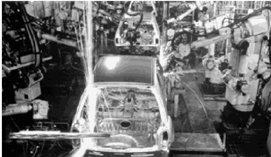
6.1 Elektr bilan payvandlash kompleksi
