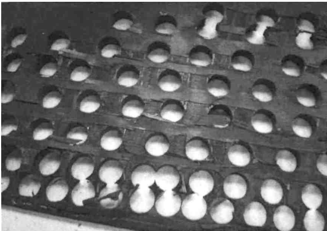
46-расм. Ўтиш S=0,12 мм/айл бўлганда асбобнинг чиқишида киришида тешикнинг фотоси
