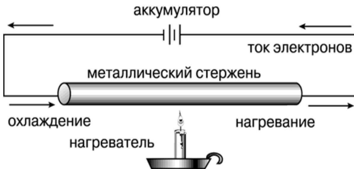
Рис. 1.4. Электротермический эффект Томсона. При пропускании тока через проводник, нагреваемый в средней точке, один его конец немного нагревается, а другой слегка охлаждается – это зависит направления тока в цепи [2].
