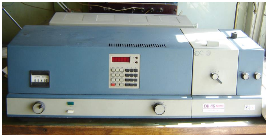
3-расм. СФ-46 спектрофотометри (Россия).
