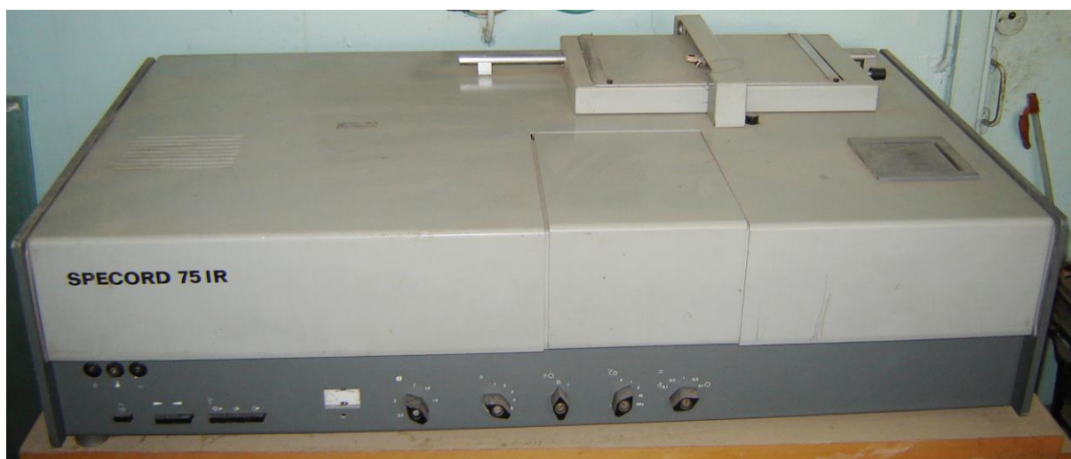
13-расм. Спекорд-75 спектрометрининг кўриниши (Германия). и Спектрометрлар қандай нусхада бўлмасин уларнинг оптик чиз- маси бир-бирига жуда ўхшаш бўлади (14-расм).
