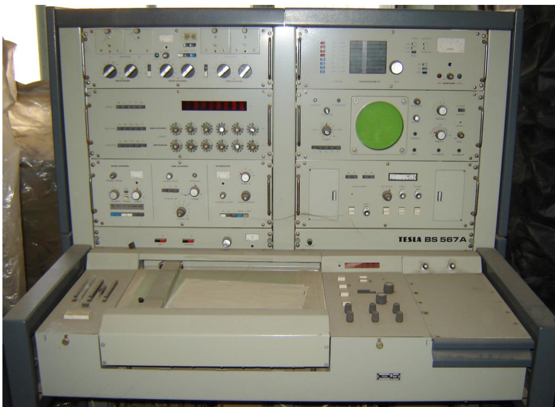
31-расм. "Тесла" фирмасининг 100 МГц ли ЯМР спектрометри. (Чехословакия).
