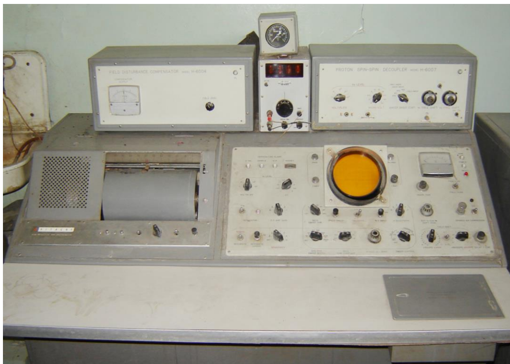
29-расм. "Хитачи" фирмасининг Н-60 ЯМР спектрометри (Япония).
