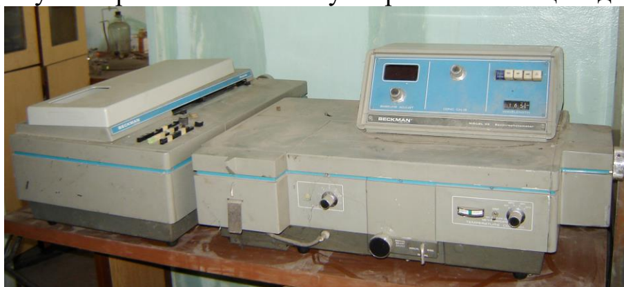
4-расм СФ-25 спектрометрининг кўриниши (Бекман фирмаси, Германия).
