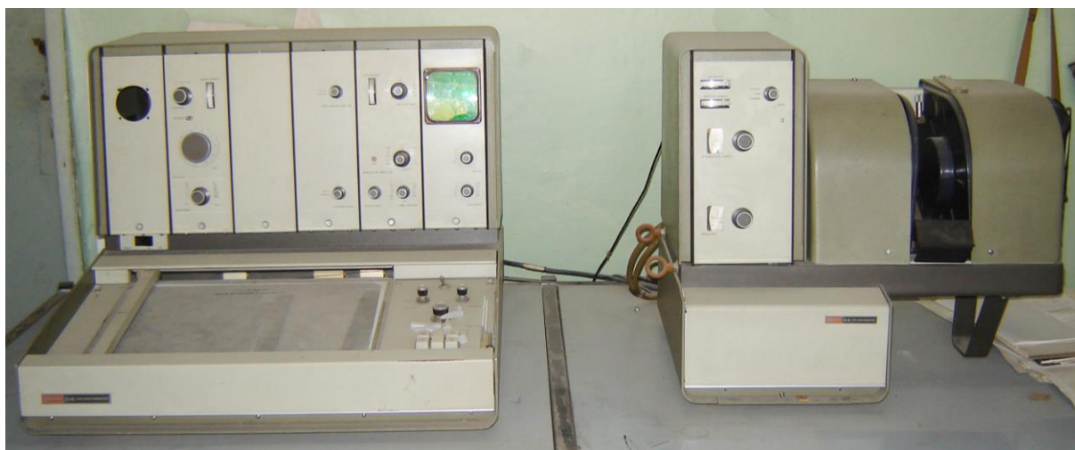
53-расм. Е-4 нусхали ЭПР спектрометрининг (Вариан фирмаси, Германия) кўриниши.
