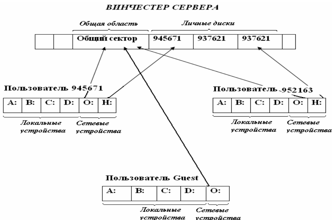
Рис. 4. Схема использования локальных и сетевых устройств памяти в иерархической сети
