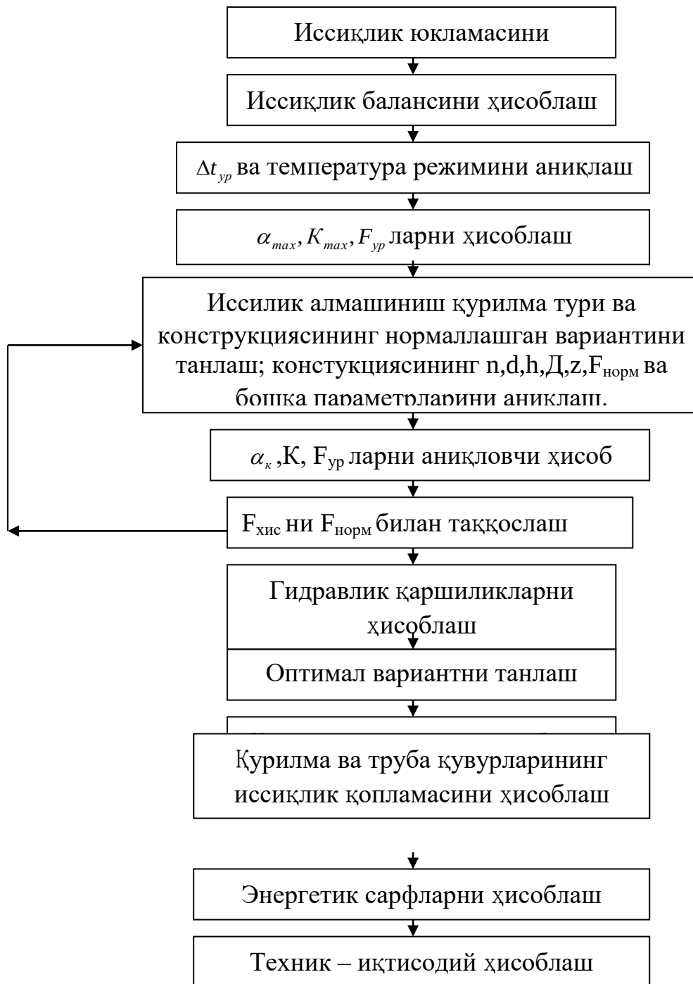
3.1 - rasm. Issiqlik almashinish qurilmasini hisoblash sxemasi.
