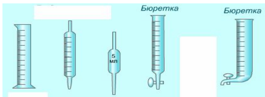
2.4- rasmlar. O'lchov silindri va pipettkalari
