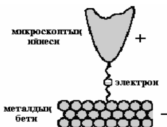
Tunnellik mikroskop. Tunnellik toqtın` shaması iynenin` ushı menen bet arasındag'ı qashıqlıqqa baylanıslı.
