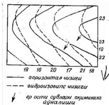
7.6 – расм. Гидроизогипс харитаси: 1 – горизонтал чизиқ; 2 – гидроизогипс чизиқ; 3 – ер ости сувлари оқимининг йўналиши.
