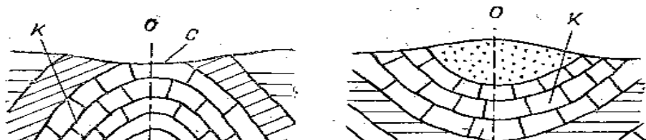
5.1 - расм. Букилмалар ва уларнинг элементлари:
