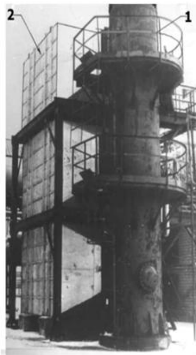
1.5.2 – расм. Фталевий ангрид ишлаб чиқаришда атмосфера ҳавосини тозалаш қурилмаси: 1-ҳаво тозалаш қувири; 2 – Д33 филтрлари
