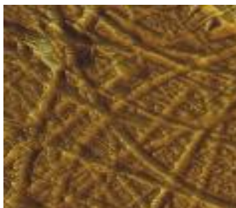
3.2.1-расм. Со-АН нанотолаларини нотўқима материалда жойлашинининг атомли-кучайтиргичли микроскопия (АСМ) ёрдамида олинган тасвири.
