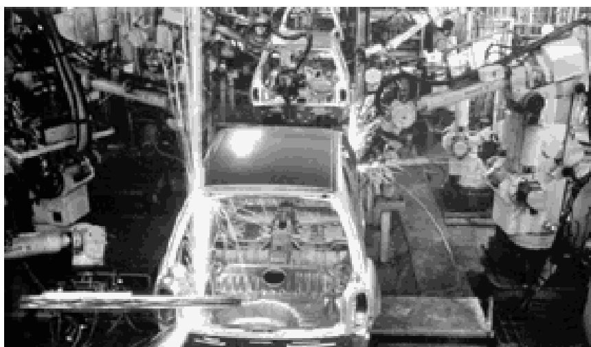
6.1 Elektr bilan payvandlash kompleksi
