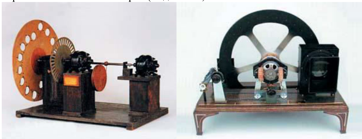
Рис.1.2 Дисконная ТВ камера Бэрда и устройство электромеханического телевизора
