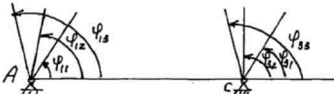
2.19-шакл. Айлангич-чайқалгичли механизмнинг уч ҳолатига қараб синтези.
