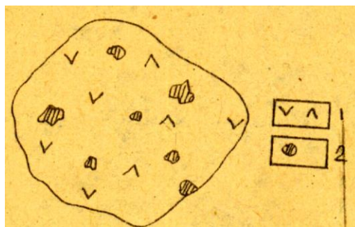
21-расм. Мис-молибден конидаги холланма руданинг кўриниши. 1-сиенит-диорит; 2-халькопирит минерали.
