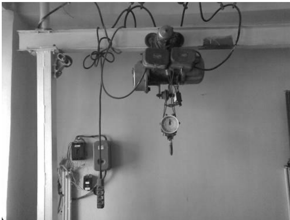
7.1. Расм. Кран аравачаси тортиш коэффицентини аниқлаш қурилмаси.
