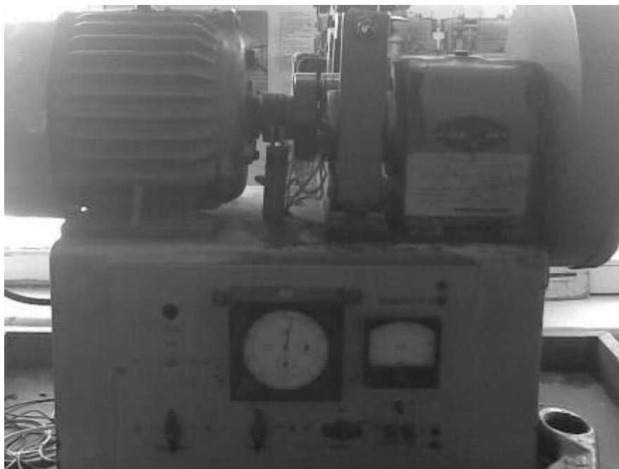
4.3-расм. Икки колодкали тормозли синаш қурилмасининг умумий кўриниши.
