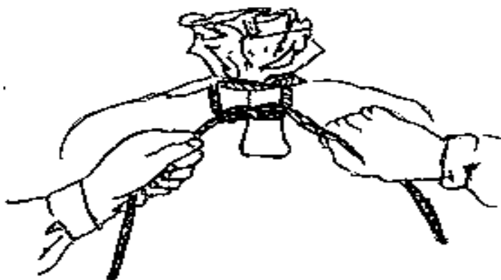
Рисунок 6 Образец заделки страховых мешков с помощью шпагата
