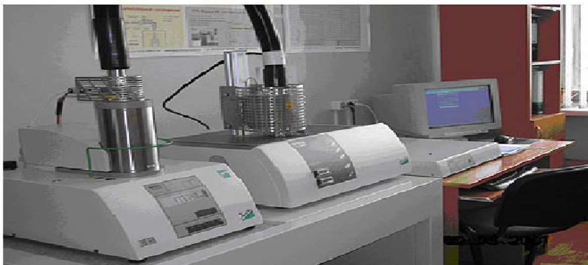
2.14 – rasm. STA 409 PC Luxx differensial termik tahlil qurilmasining umumiy ko'rinishi
