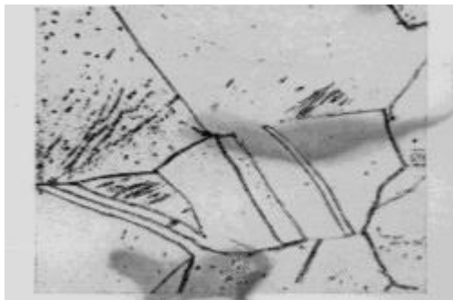
16.1-rasm. Deformatsiyalanib, so'ng yumshatilgan misning mikrostrukturasi. Metalga temir xloridning xlorid kislotasidagi eritmasi bilan ishlov berilgan, x200.
