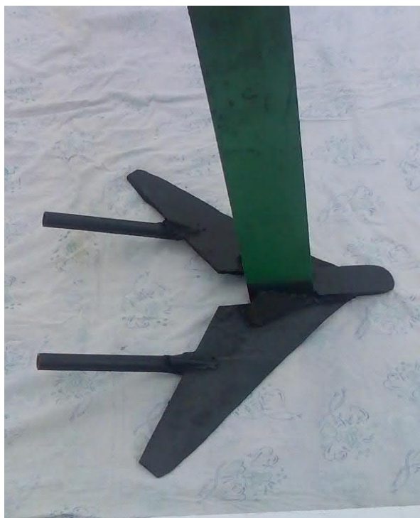
2-расм. Универсал культиваторнинг ишчи органи-ясси кескич.
