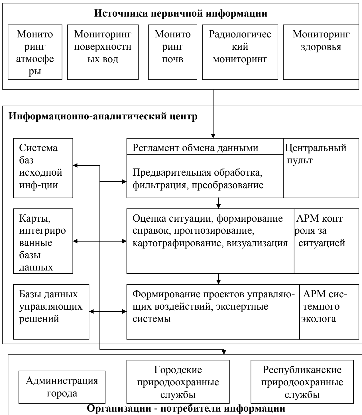
Рис 8.1. Информационное обеспечение системы экомониторинга
