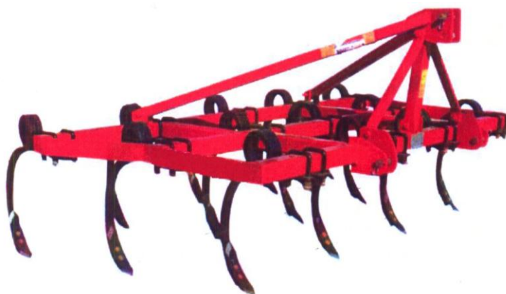
3-расм. Туркия DAIICHI AGRO MACHINE фирмасининг пружинасимон устунли чизелли плуги
