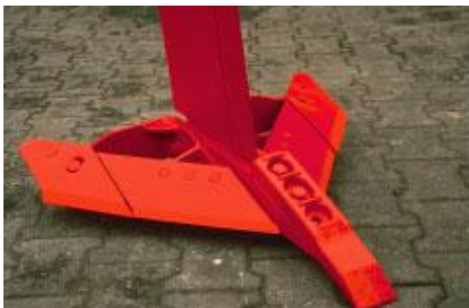
8-расм. ГР туридаги чуқурюмшаткич иш қуроли
