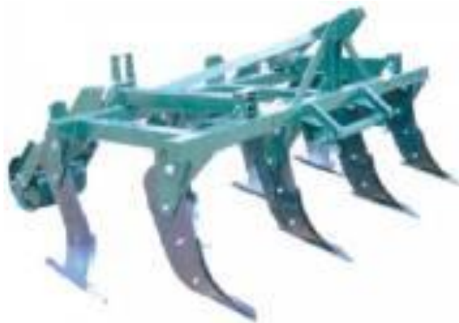
7-расм. Тупроқни бир томондан юмшатувчи чуқурюмшаткич
