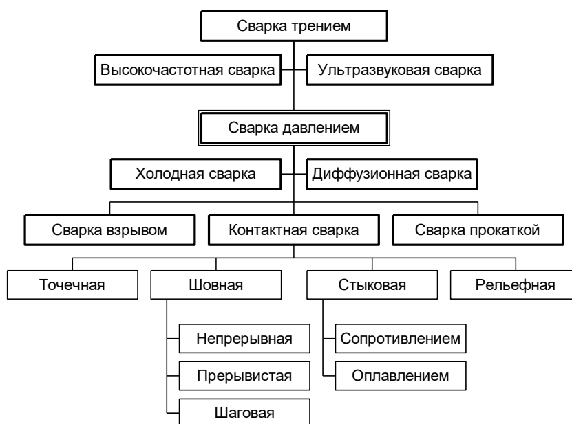
Рис. 3.1. Классификация способов сварки давлением.
