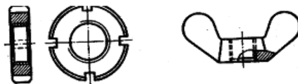
Рис. 4.18 Гайка круглая и гайка барашек
