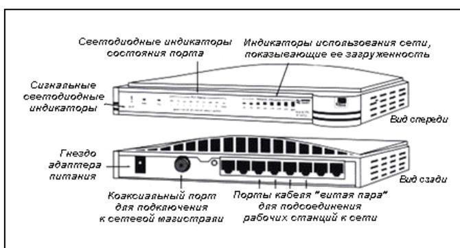
**концентратором** (или **коммутатором**).
