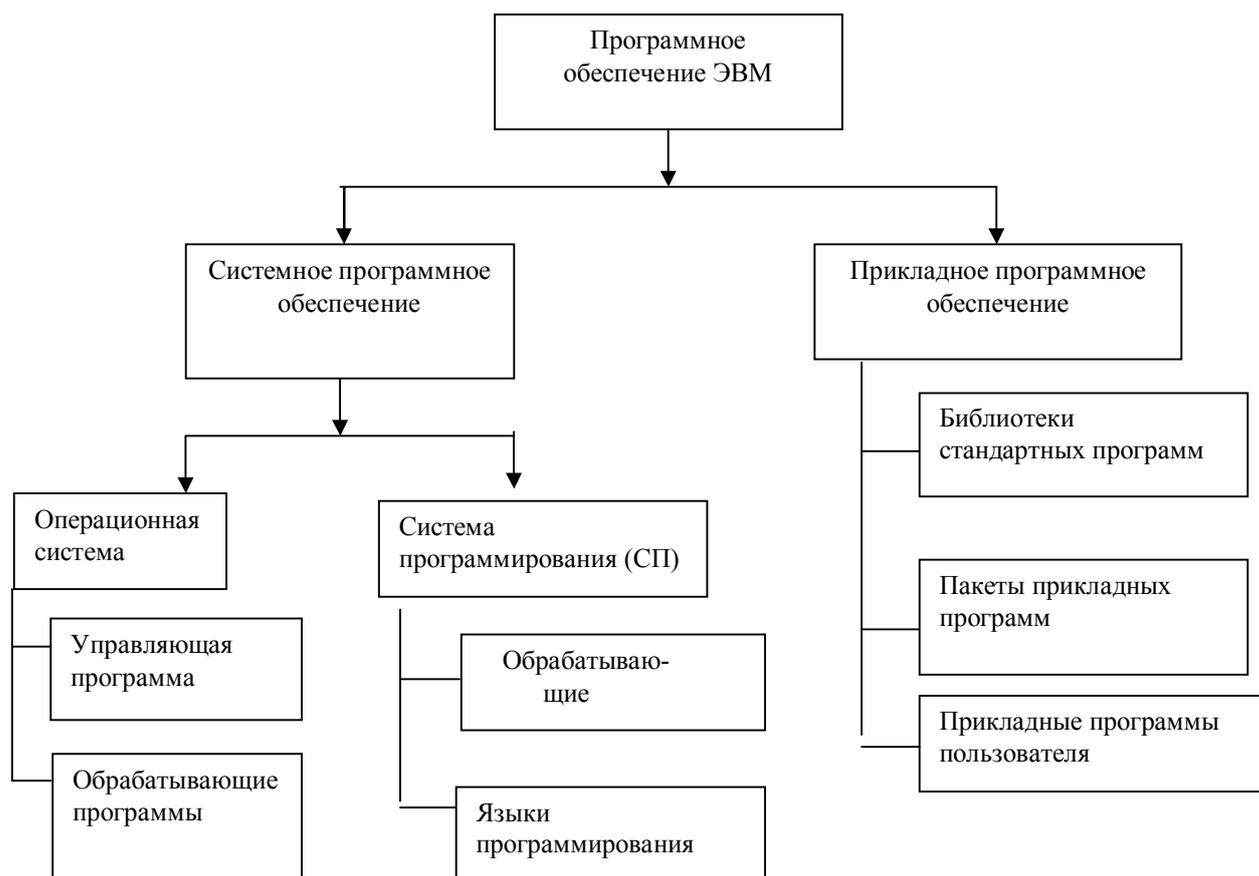
Рис.1. Структура программного обеспечения.
