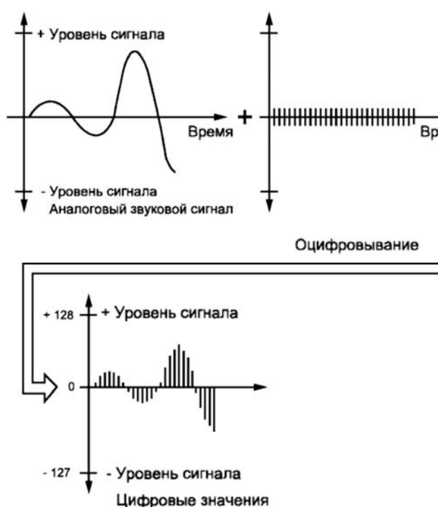
Рис. 12. Преобразование звукового сигнала в цифровую форму
