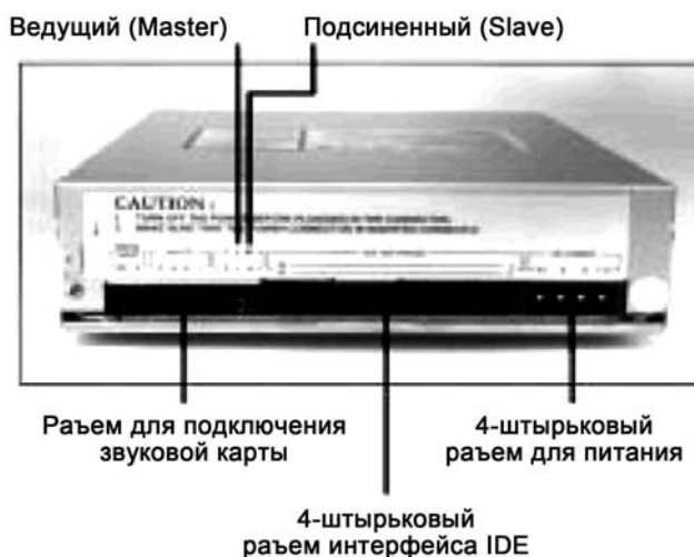
Рис. 9. Задняя сторона типичного накопителя CD-ROM с интерфейсом IDE
