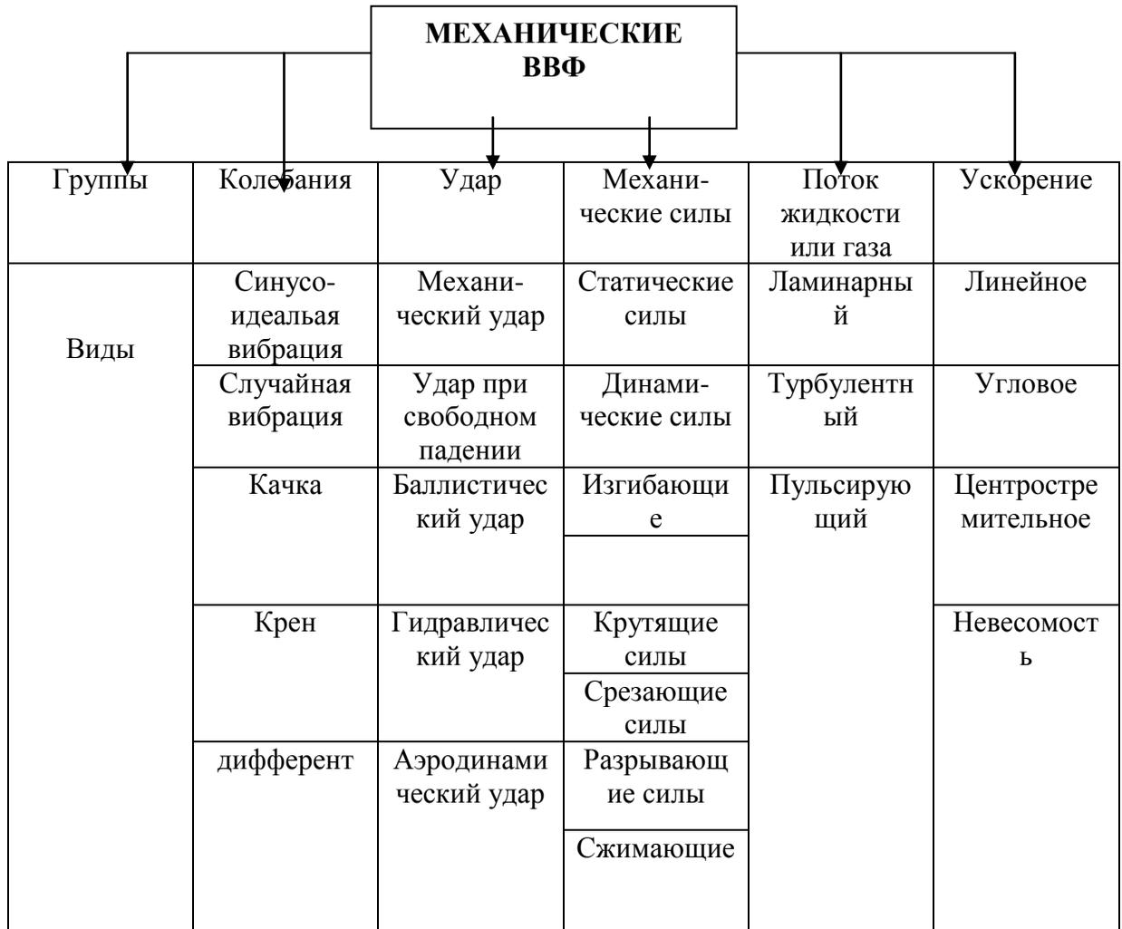
Рис. 16.1. Классификация механических ВВФ
