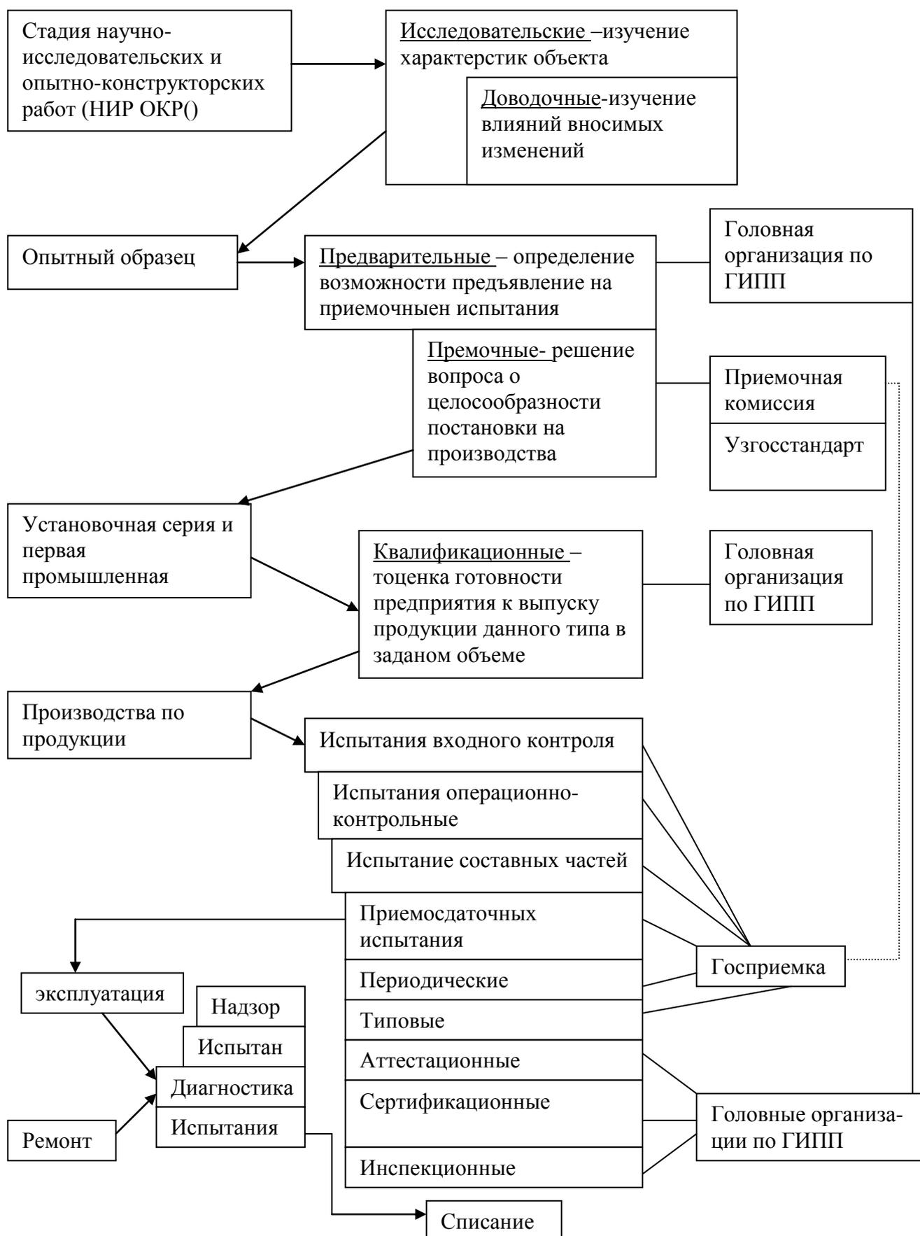
Рис.4.2. Испытания на различных стадиях жизненного цикла продукции (изделия)
