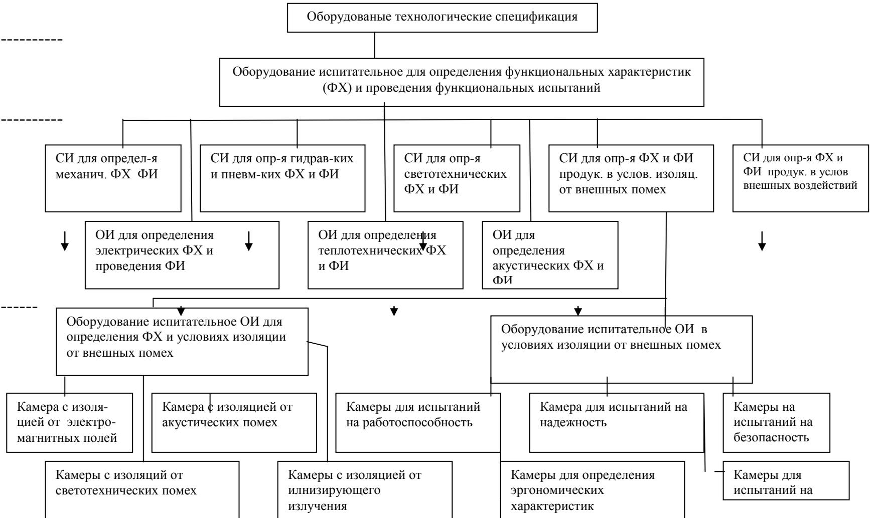
Рис. 16.2. Классификация ИО для определения ФХ и ФИ
