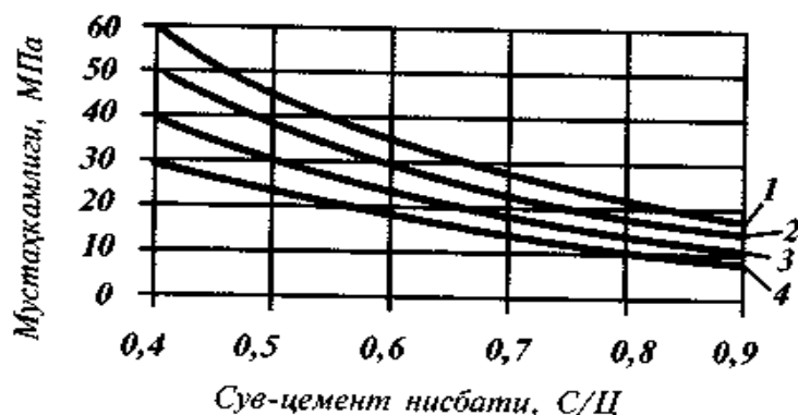
3-расм. Бетон мустаҳкамлиги билан С/Ц нисбати ўртасидаги боғланиш: 1-M600; 2-M500; 3-M400; 4-M300.
