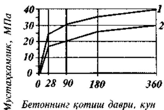
1-расм. Қумдаги органик аралашмаларнинг бетон мустаҳкамлигига таъсири: 1–тоза қум; 2– органик аралашмали қум.
