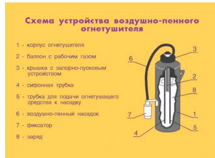
Схема устройства воздушно-пенного огнетушителя
