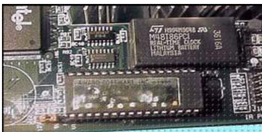
Рис 2. Интегральные схемы BIOS и CMOS
