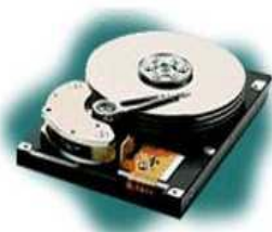
Рис. 5. Винчестерский накопитель со снятой крышкой корпуса
