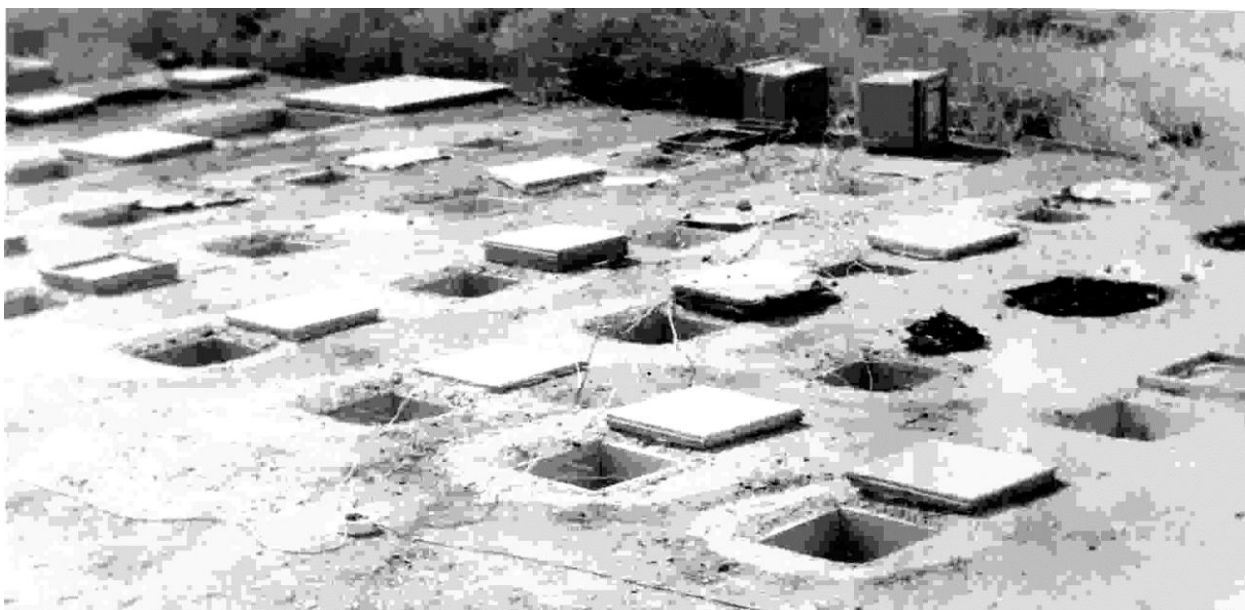
5-расм. Бетонни парваришлаш усулларини синаш жараёни
