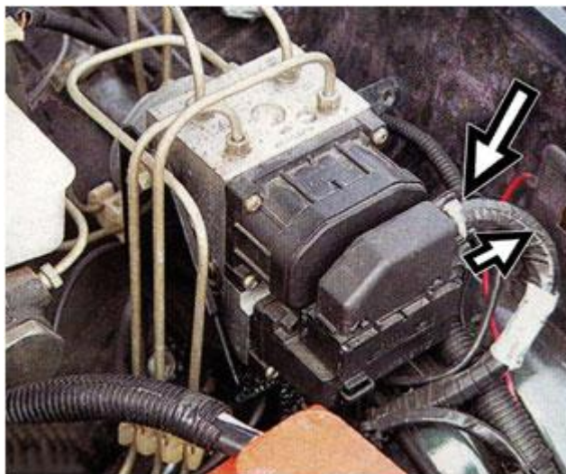
Рис.11. Отсоединение колодки проводов жгута АБС от штекерного разъема электронного блока управления гидроагрегата
