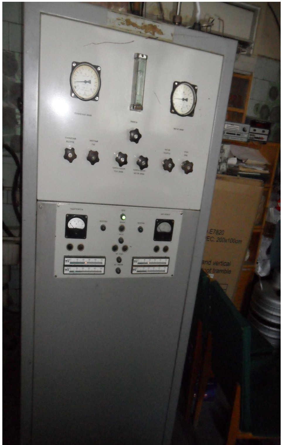
20-расм. Эксперимент ўтқазиш вақтида водород “Палладий-2” қурилмаси асосида, кераксиз ифлосланишлардан наъмуна устиришда тозаланади.
