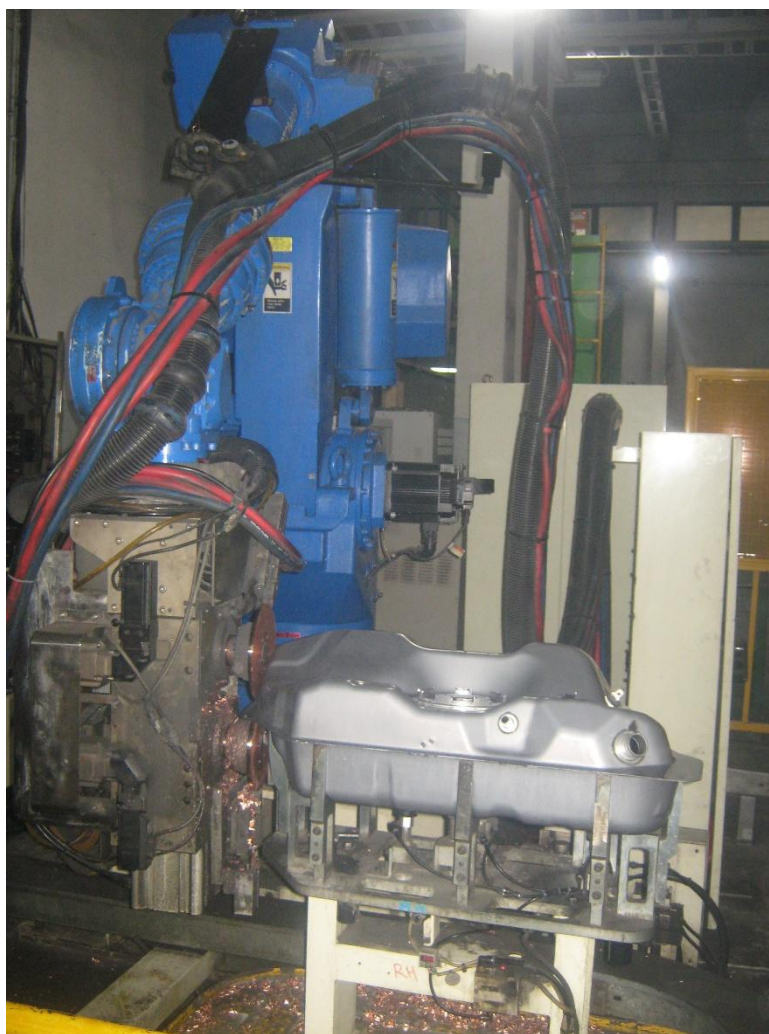
5.1-rasm. Rolikli payvandlash jarayoni.
