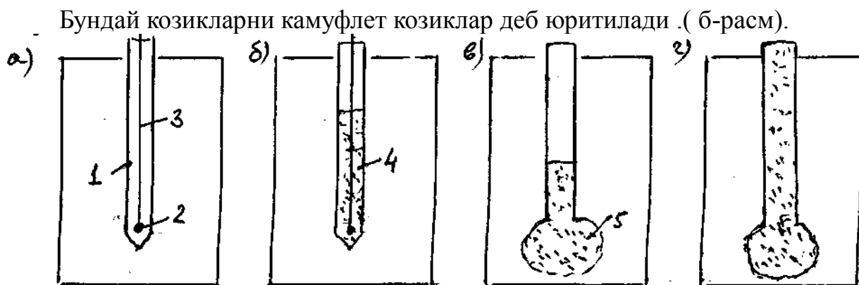
б-расм. Камуфлет козик урнатиш чизмаси: 1-кувур; 2-портловчи модда; 3-симлар; 4-суюк бетон; 5-камуфлет кенгайтирилган кисми.
