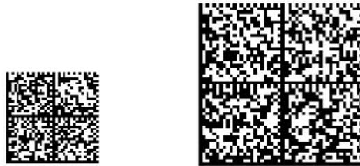
Рис 2(б). Двухмерный штрихкод – Data Matrix
