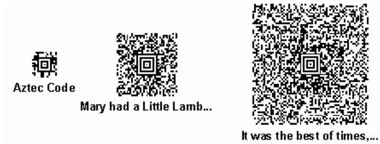
Рис 2(а). Двухмерный штрихкод – Aztec Code
