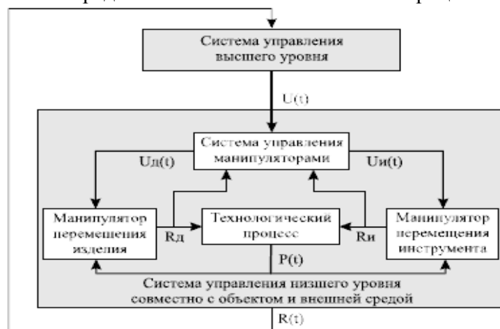
Рис. 29. Структура робототехнической системы
