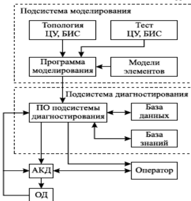
Рис. 7. Общая структура экспертной системы диагностирования
