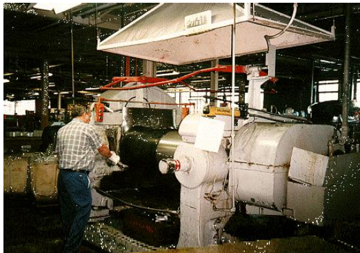
Рис. 80.4 Более старые вальцы с расцепляющей штангой, расположенной слишком высоко, для того чтобы быть эффективной. Оператор, однако, носит большие перчатки, которые будут затянуты в вальцы раньше его пальцев
