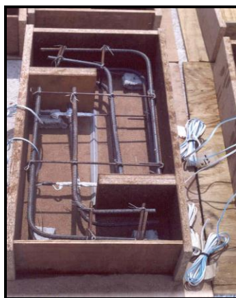
Рис. 2.3 (b). Размещение арматур, положение нареза у основания специальных образцов с поперечными арматурами поперек плоскости среза
