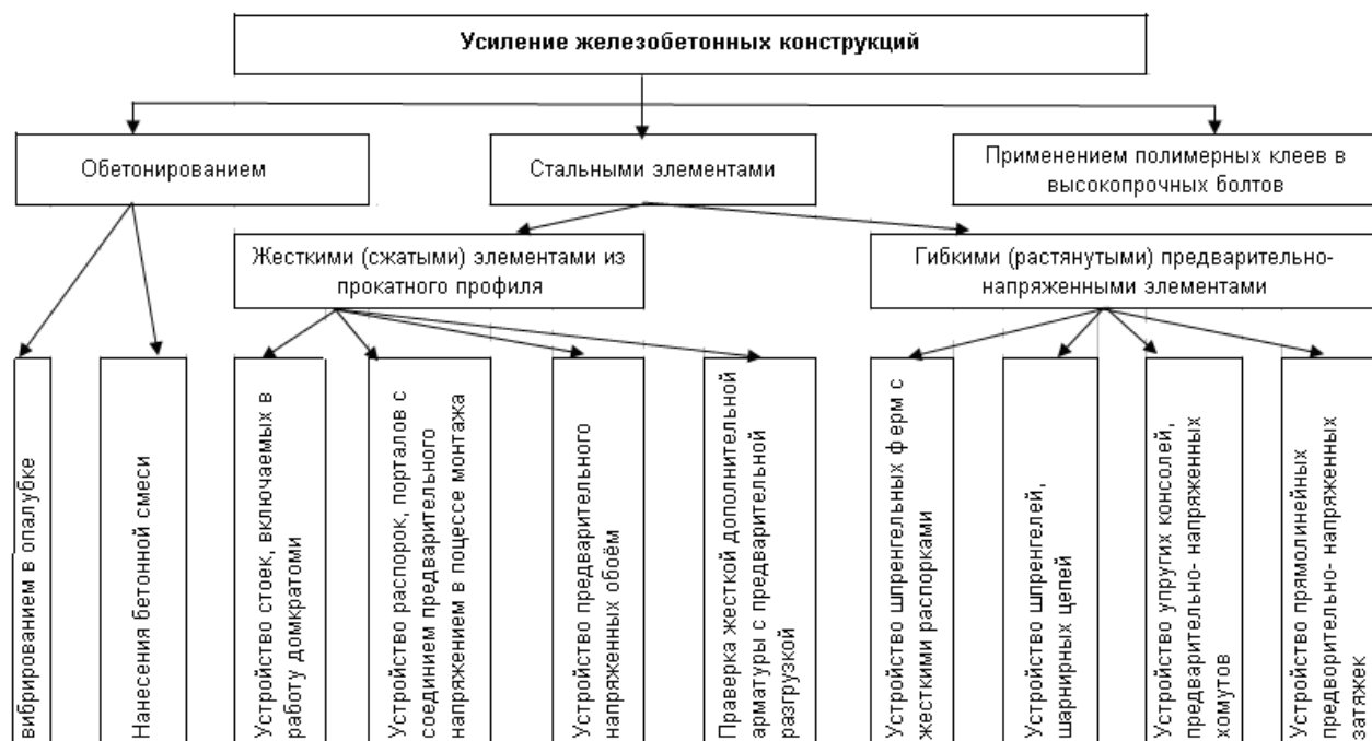
Рис. 1.8. Классификация способов усиления железобетонных конструкций по виду материала усиления.
