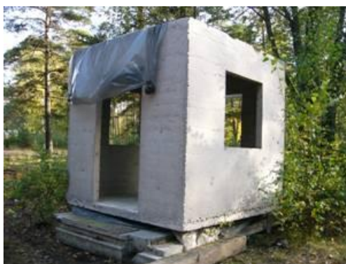
Рис. 1.1. Объемный железобетонный блок, предназначенный для испытаний
