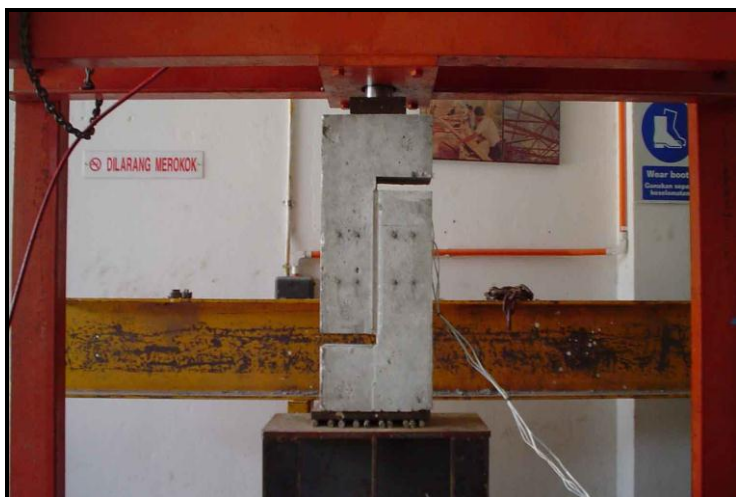
Рис. 2.16. Экспериментальная установка специальных образцов под прямым грузом среза
