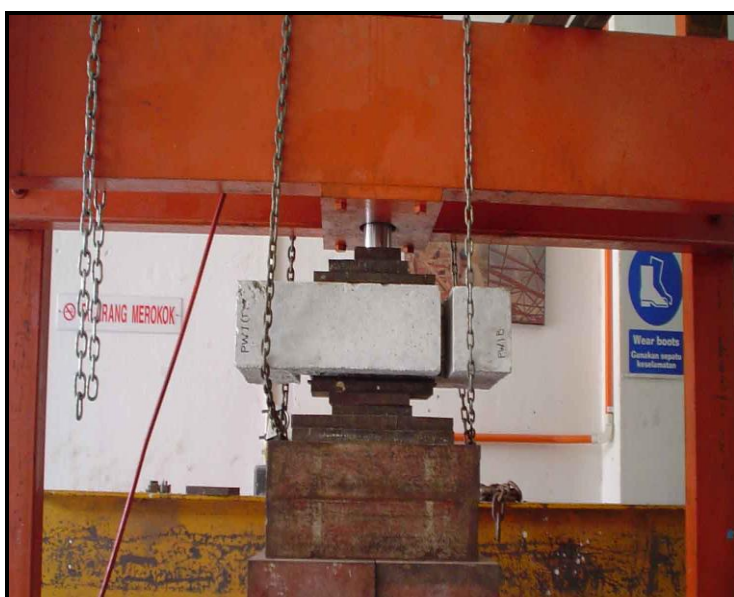
Рис. 2.15. Специальный образец, подвергнутой линейной нагрузке по плоскости среза
