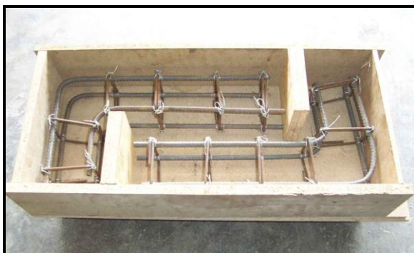
Рис. 2.3 (а). Размещение арматур специальных образцов без хомутов поперек плоскости среза
