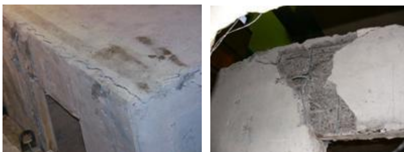
Рис. 1.4. Характерные повреждения железобетонного блока после достижения максимальных усилий
