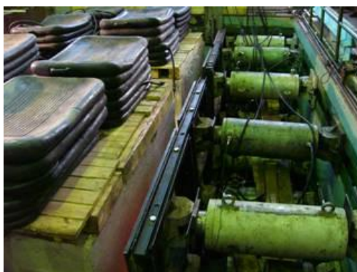
Рис. 1.2. Размещение моделей в силовом стенде для создания горизонтальной статической нагрузки
