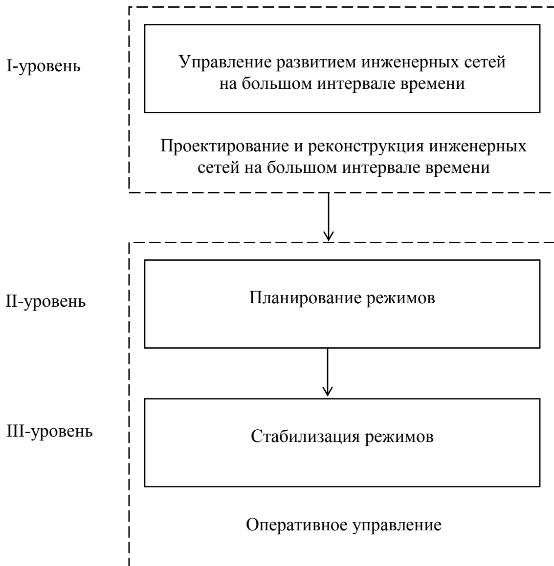
Рис.1.1. Схема управления потокораспределением в инженерных сетях на различных интервалах времени.
