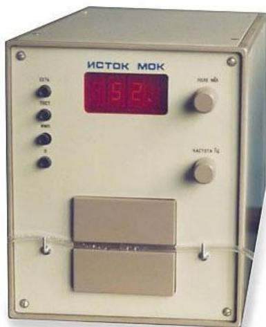
Аппарат обладает микропроцессорной схемой измерения, управления, стабилизацией параметров магнитного поля. На цифровом индикаторе выводятся значения частоты и значение магнитной индукции. Воздействует на кровь пульсирующим или постоянным магнитным полем в составе аппарата АУФОК-01 «Исток-2», а также в других комплексах обработки крови. Диапазон параметров магнитного поля составляет 10-100 мТл, 0-100 Гц.
