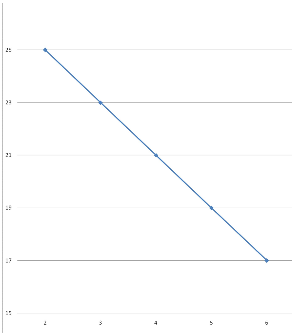
Рис.2.1. График влияния числа зарубок (заправочного натяжения) на процент сильно натянутых нитей по ширине ткани.
