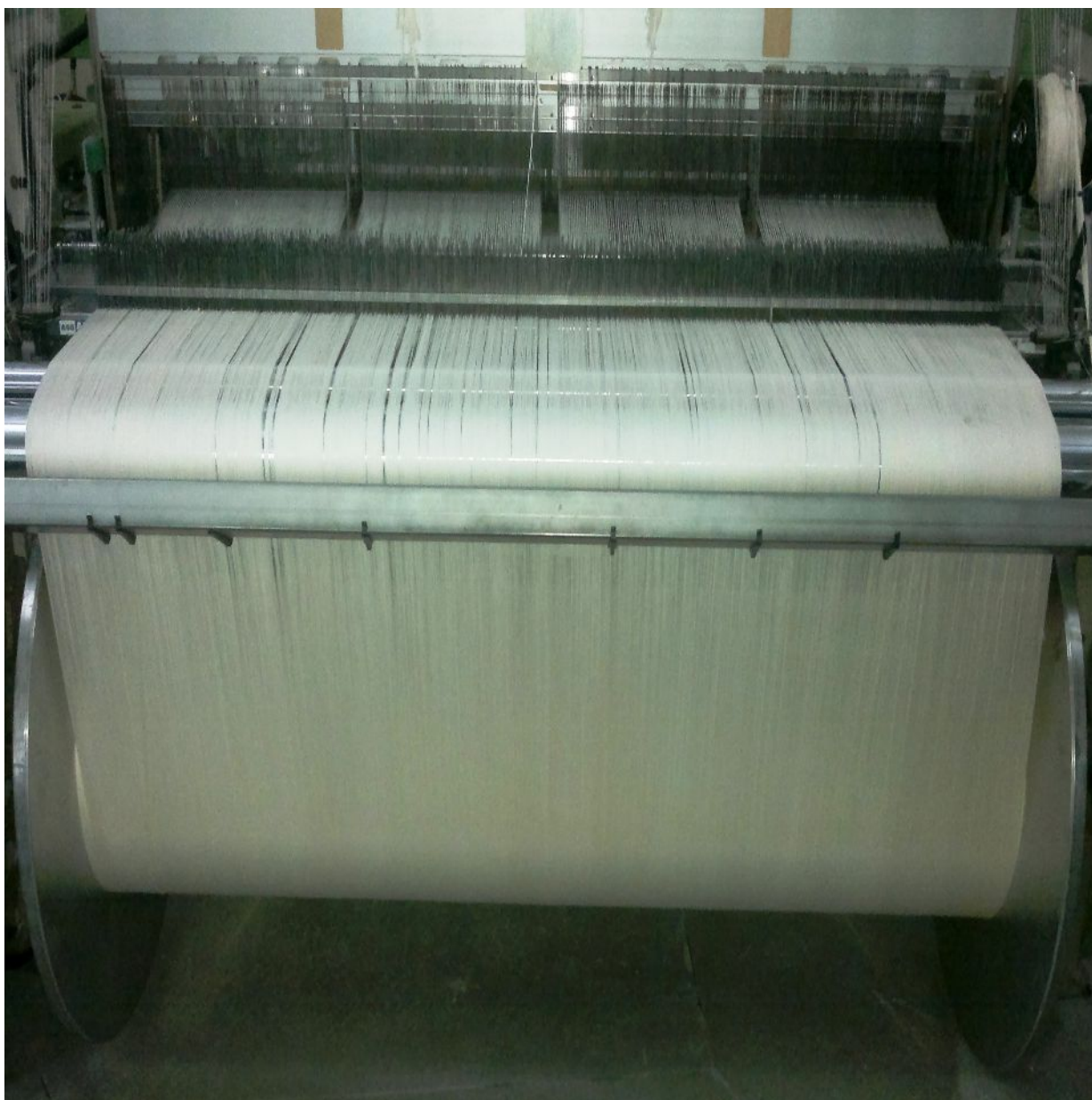
Рис.2.5. Ширина заправки ткацкого станка со стороны навоя слева → направо для микрошелочных и рапирных станках.
