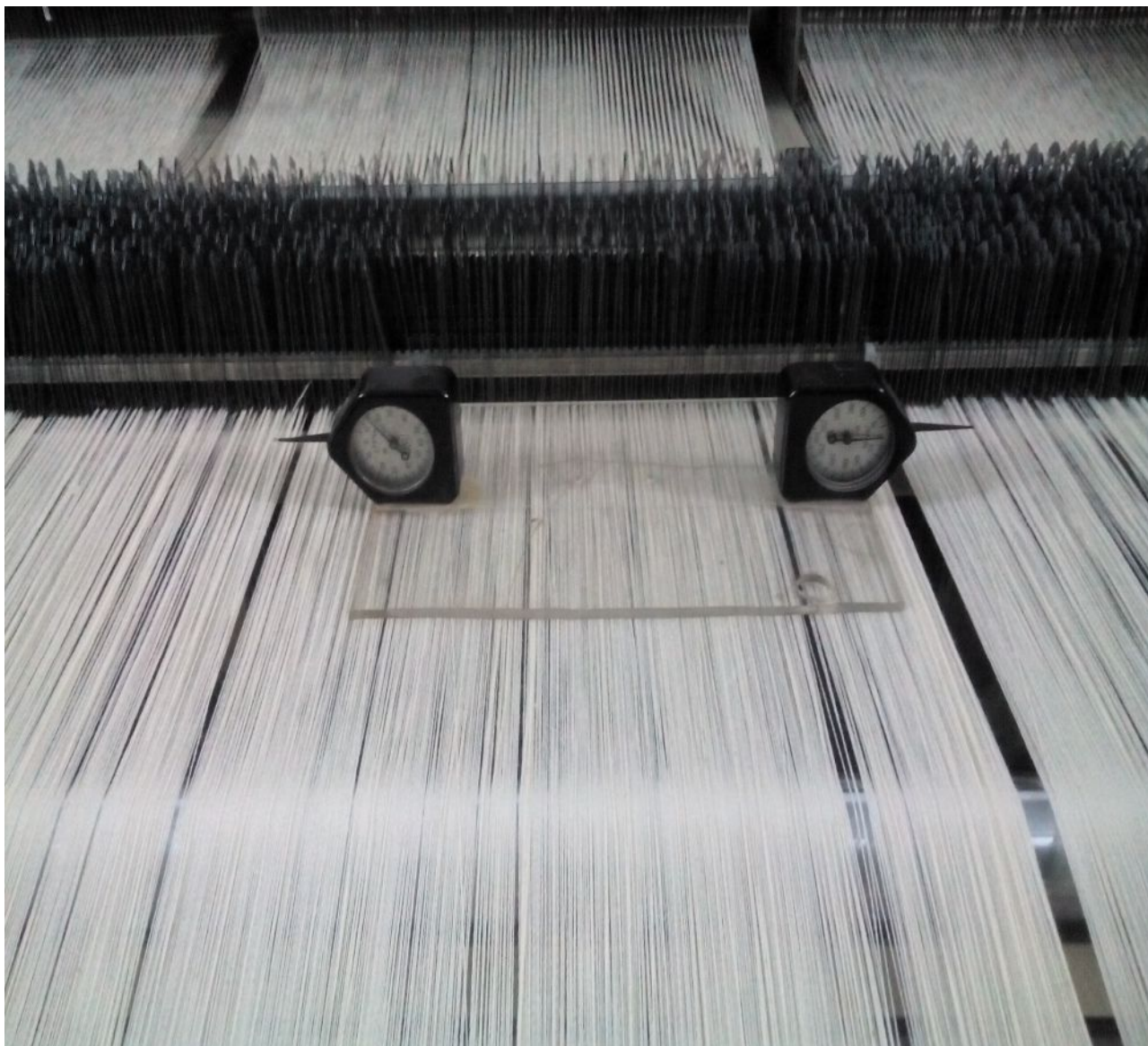
Рис.2.4.Прибор для измерения натяжения одиночных основных нитей на ткацком станке.
