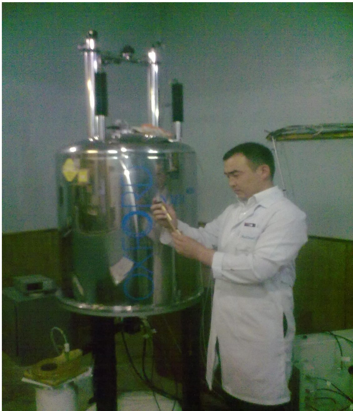
11-rasm. Varian (AQSh) firmasining protonlar uchun rezonans chastotasi 400 MGs bo'lgan YaMR spektrometri.
